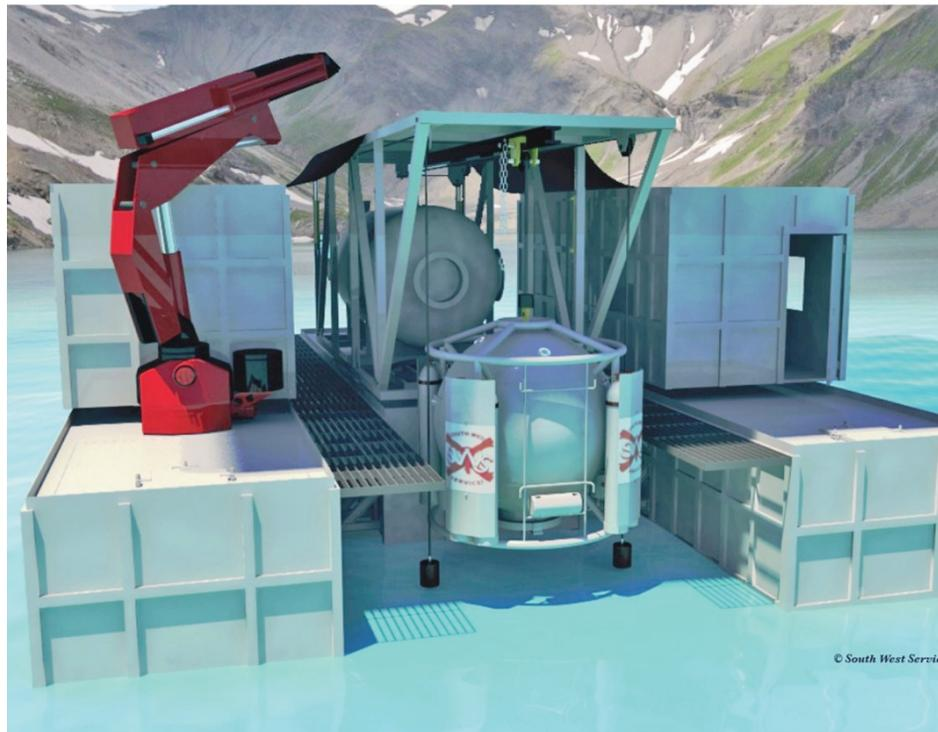
Le système mis au point par Alain Hill est adapté des techniques offshore utilisées notamment sur les plateformes pétrolières. Si les premiers clients visés sont les exploitants hydro électriques, l'entrepreneur estime qu'il pourrait, entre autres, servir à l'assainissement des cours d'eau, aux opérations de secours... SWS
